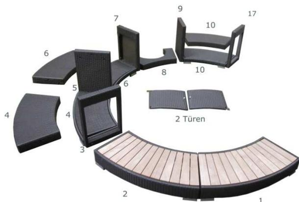
Beachten Sie bitte, dass die Beine 3 und 17 links und rechts neben dem Einstieg zu montieren sind. Achten Sie beim Befestigen auch darauf, dass sich die oberen Schraubenhülsen auf der Innenseite, abgewandt vom Einstieg, befinden. In der Vorderansicht sollen somit oben an den Beinen keine offenen Schraubenhülsen sichtbar sein. Sie haben jetzt zwei Möglichkeiten Beine Nr. 3 und 17 zu verschrauben.
